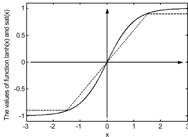
Fig. 3. The function  $\tanh(x)$  and  $\text{sat}(x)$ .
